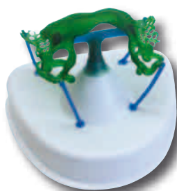
Beispiel: 3D-Druck in 350 g Muffel
